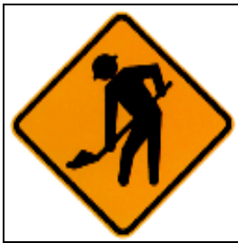
Figura No 3. SPO 01 - TRABAJOS EN LA VÍA
