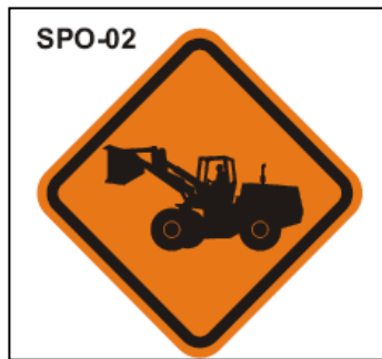
Figura No 4. SPO 02 - MAQUINARIA EN LA VÍA
