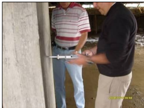
Figuras 109. Pruebas con el Esclerómetro
