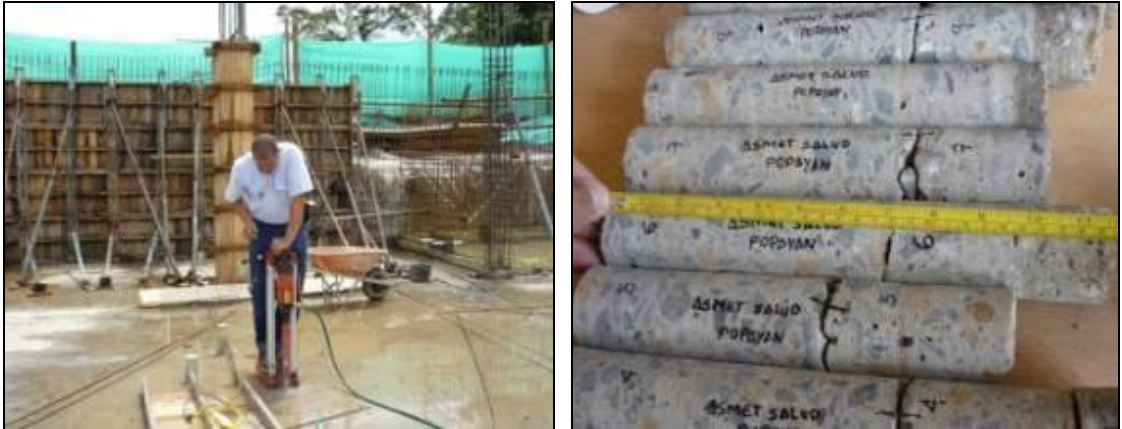
Figuras 17 y 18. Extracción de núcleos y medición de los mismos
