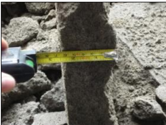
Figuras 82 y 83. Espesor de los repellos e instalación del refuerzo
