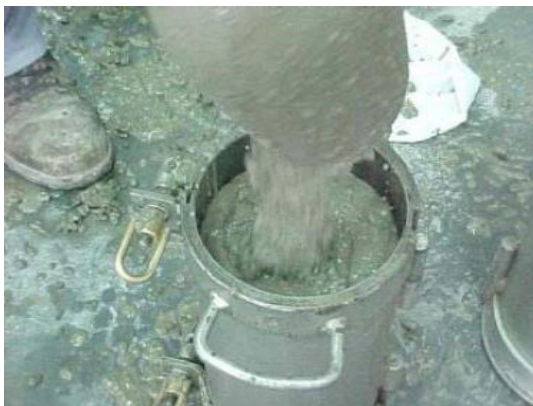
Concreto autonivelante sin compactación.
