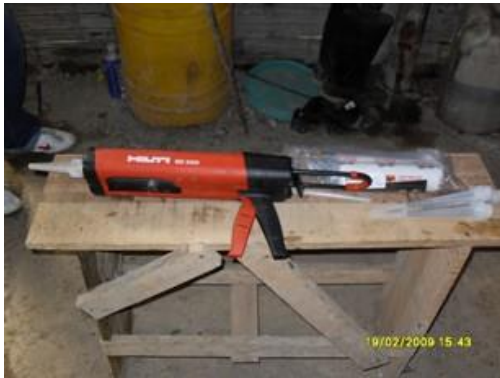
Aplicador epóxico anclaje.
