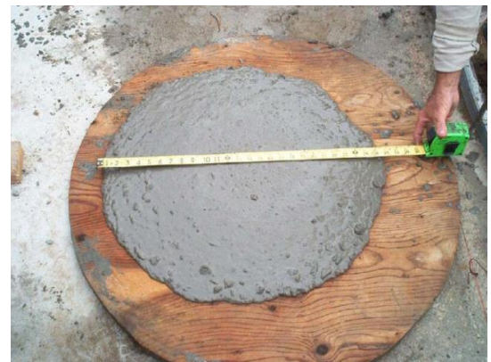
Diámetro = 67.5 cm (tolerancia 65 +/- 5 cm).
