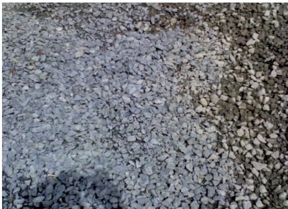
FOTO N°53: GRAVA UTILIZADA PARA LAS MEZCLAS DE CONCRETO
