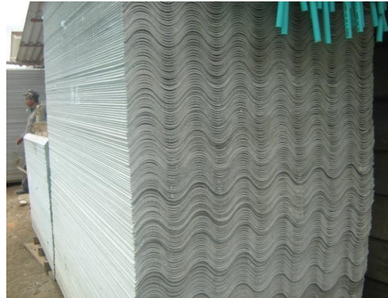
FOTO N°144: HOJAS DE ETERNIT PARA LA CUBIERTA
