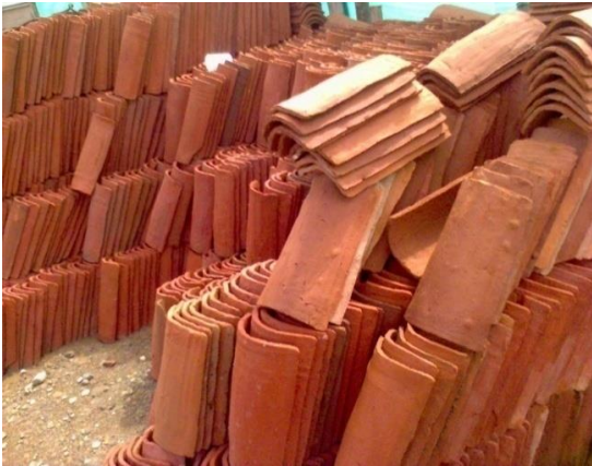
FOTO N°149: TEJAS DE ARCILLA PARA LA CUBIERTA
