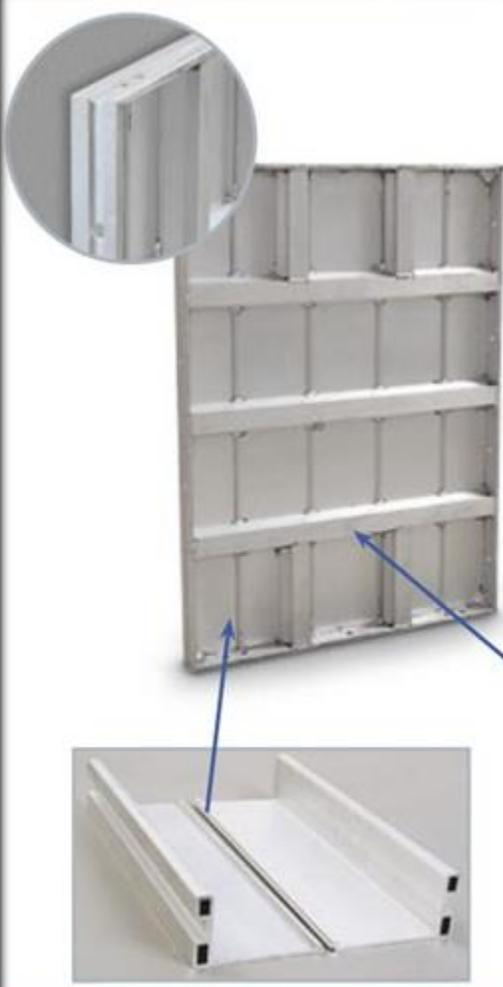
Las formaletas son fabricadas con perfiles extruidos de aluminio, de aleaciones 6061 y 6261 temple 6, los cuales se unen machibrados entre sí, con soldadura de aluminio 5356. Refuerzos transversales de 7.5 cm, que garantizan un mejor comportamiento a la deformación de los paneles en servicio.
