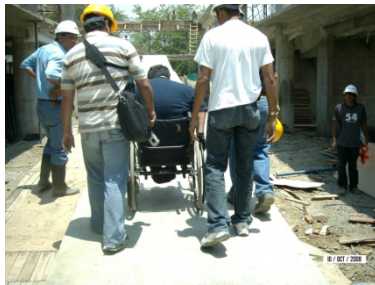
Prueba de pendientes por PMR
