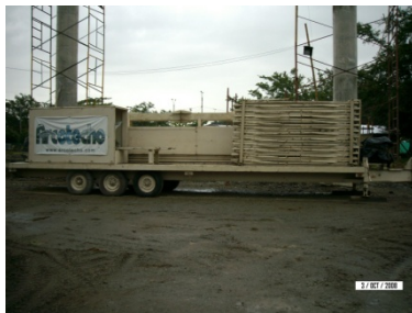
Maquinaria de arcotecho
