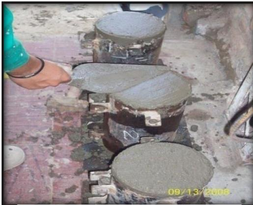
a) Cilindros para Resistencia
