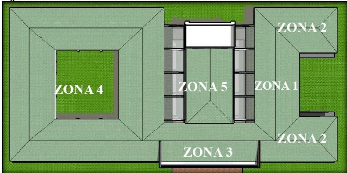
La edificación, debido a su diseño, está dividida en 5 zonas estructurales que trabajan independientemente, solo están enlazadas a través de las vigas de cimentación actuando también como vigas de amarre. Existe una dilatación de 5cm entre las vigas de cimentación de cada zona al igual que en las columnas y en las vigas aéreas. Las zonas 1,2,3 y 5 hacen parte de la BRIM 19, la zona 4
