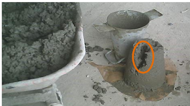
Figura 58. Prueba de slump no valida
