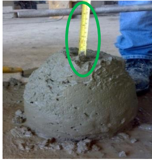
Figura 57. Slump tomado a mezcla con plastificante
