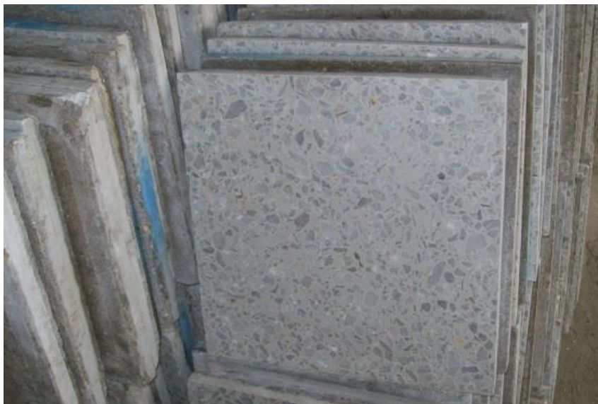
Ilustración 41, Baldosa tipo alfa por la parte superior.
