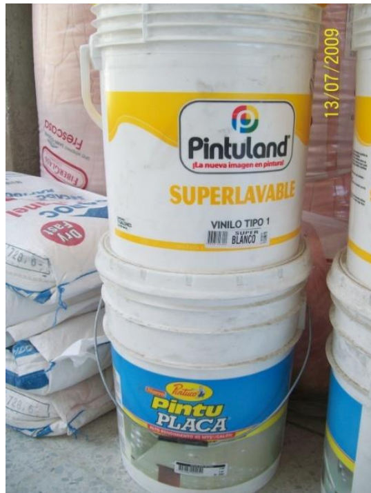
Ilustración 24, Pintura vinilica tipo I usada para pintar las placas de superboard.
