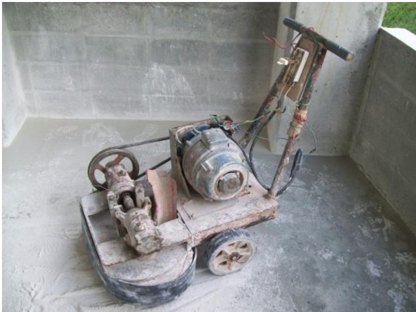
Ilustración 43, Destroncadora usada en obra.
