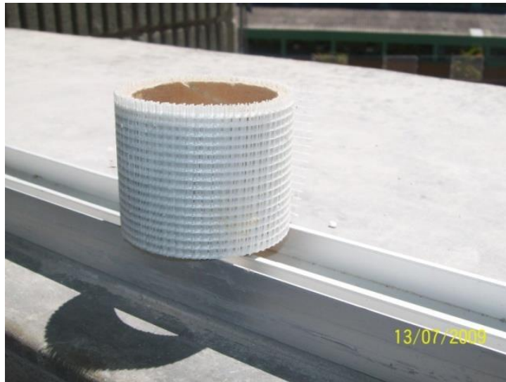
Ilustración 22, Cinta malla usada en las juntas de las placas.
