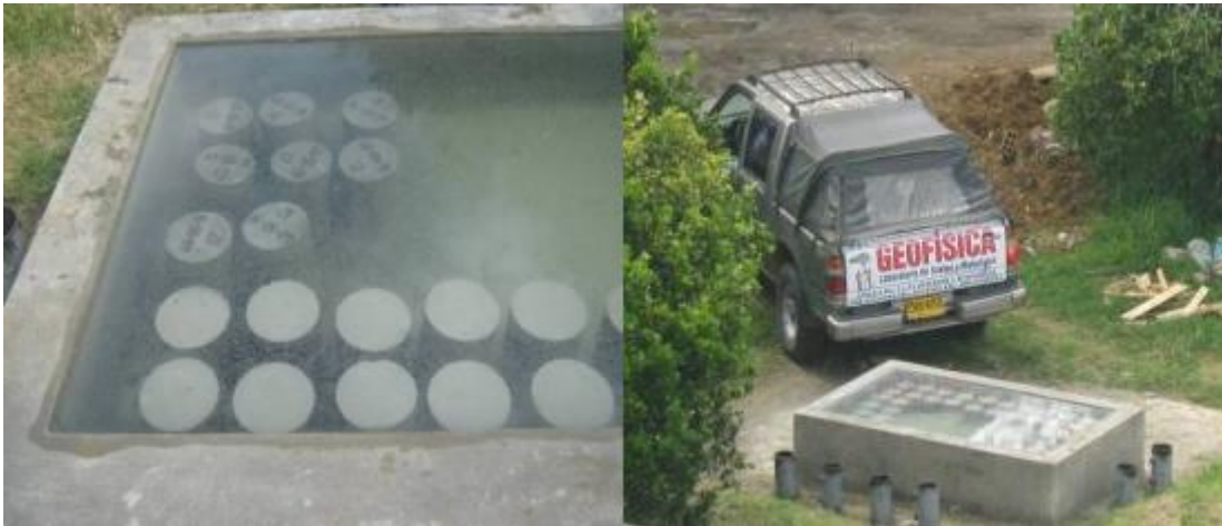
Fotografías 21 y 22 - Cámara de curado y entrega de cilindros al laboratorio para la realización de los ensayos respectivos.
