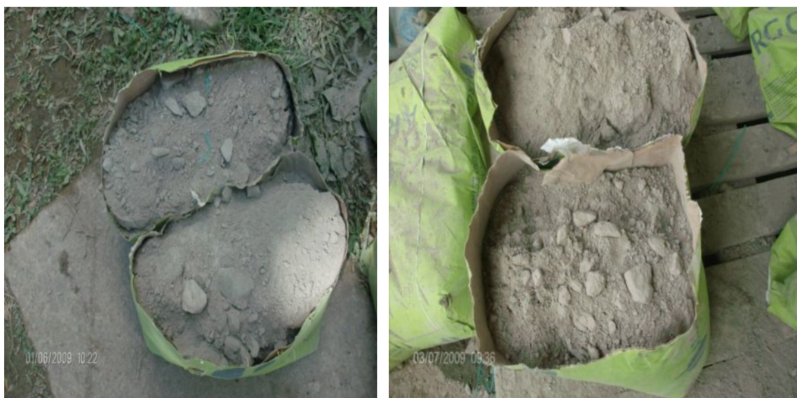
Fotografías 7 y 8 – Hidratación del cemento estructural.
