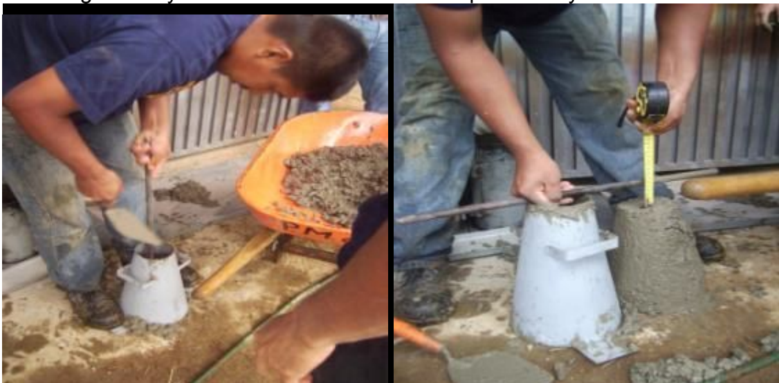
Fotografías 17 y 18 – Control de asentamiento "Slump".
