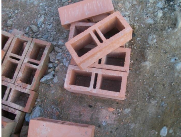
Foto 22. Ladrillo estructural utilizado para la mampostería (largo=29cm, ancho=12cm, alto=10cm)
