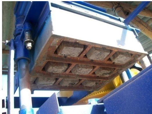
Foto 29. Modulo que forma los bloques de cemento- carbonilla
