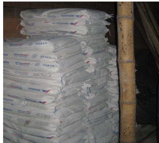
Foto 2. Bultos de cemento de 50 kg (para obra negra) y bultos de estuco de 25 kg (para obra blanca)
