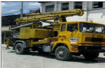
AUTOBOMBA WORTHINGTON CAPACIDAD 13.4 TON
