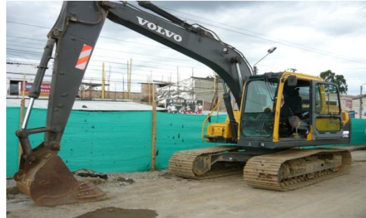
EXCAVADORA VOLVO EC 140 BLC VALDE 0.8 m 3
