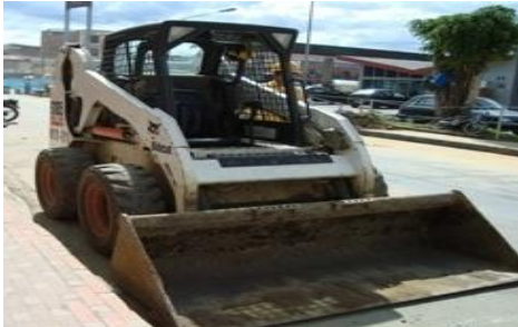
MINICARGADOR BOBCAT 185 CAPAC 0.389 TON, 0.7 m 3
