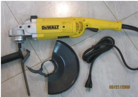
PULIDORA DEWALT POTENCIA 1800 W
