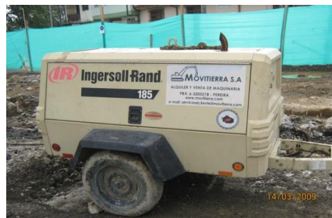
COMPRESOR INGERSOLL RAND CAPACIDAD 1.85 Lbs 2 MARTILLOS
