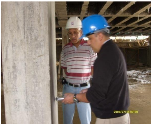
Figuras N° 127 y 128. Prueba de resistencia con Esclerómetro.
