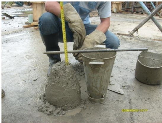
Figuras N° 98 y 99. Chequeo del asentamiento del concreto 1:2:2 para las columnas.
