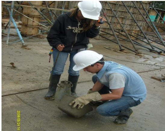
Figuras N° 96 y 97. Prueba de asentamiento para columnas.
