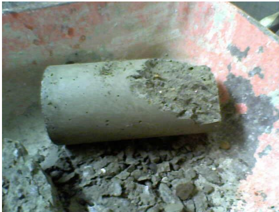
Figuras N° 133 y 134. Tipos de fallas en los Cilindros.
