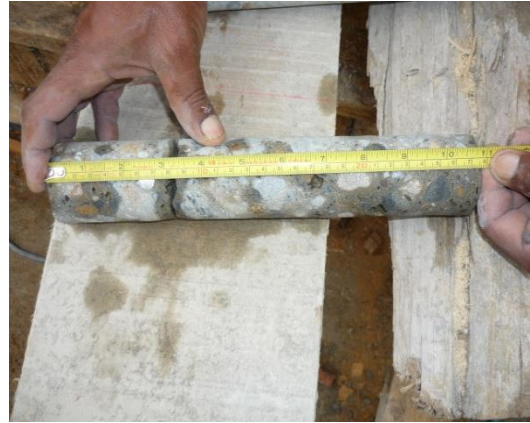
Figuras N° 45 y 46. Toma de núcleos de la losa de cimentación y toma de medidas.
