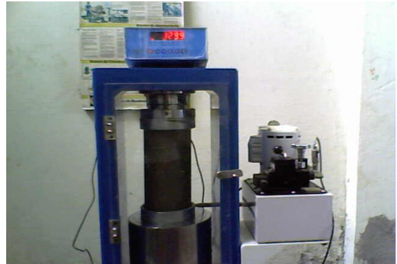
Figuras N° 131 y 132. Medidas de los cilindros y Maquina de Rotura ó Falla de Cilindros.
