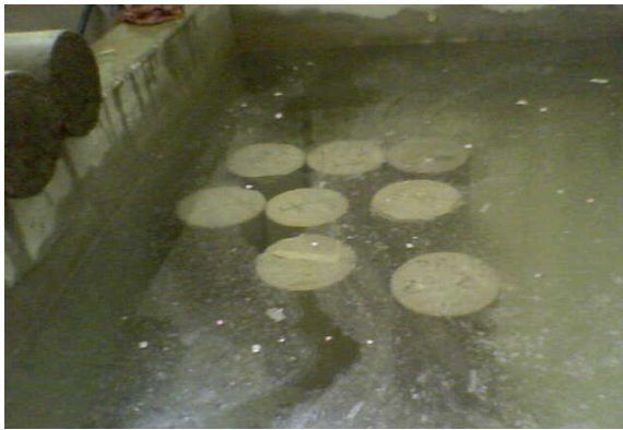
Figuras N° 129 y 130. Emersión de Cilindros y secado.
