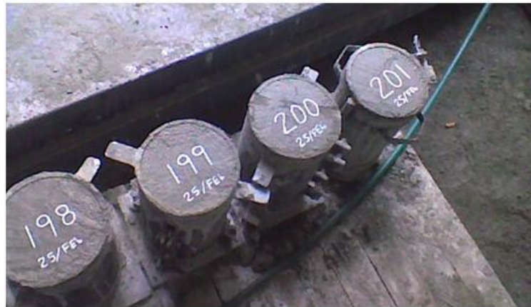
Figura 19. Muestras para ensayo de resistencia.
