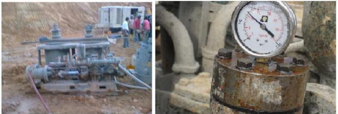
Figura 36. Equipo de inyección para anclajes
