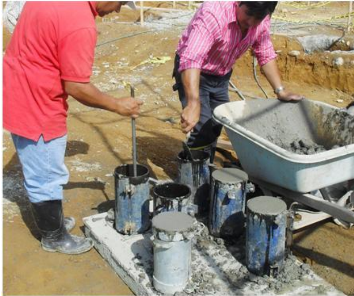
Figura 18. Elaboración de cilindros de concreto.
