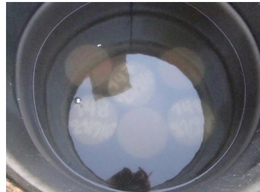
Figura N° 67. Inmersión de los cilindros en agua
