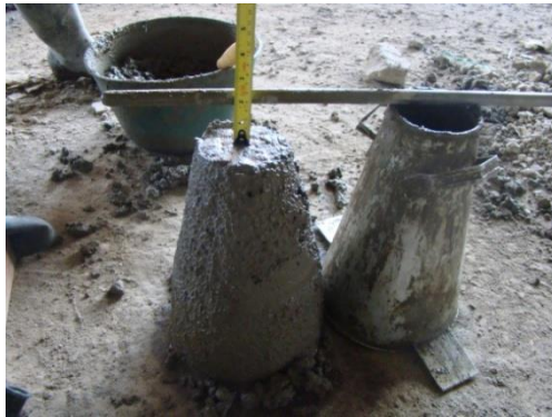
Figura N° 62. Medida del asentamiento de una mezcla de concreto con el cono o slump para la losa
