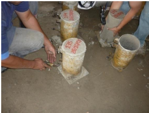
Figura N° 66. Desencofrado de los cilindros
