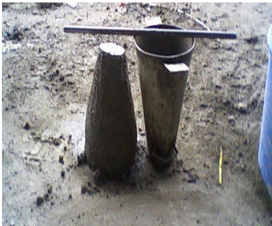
Figura 110. Slump tomado a mezcla sin aditivos Figura 111. Slump tomado a mezcla con plastificante
