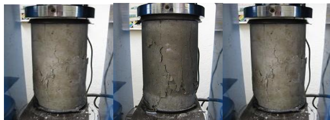
Figura 117. Rotura de cilindros
