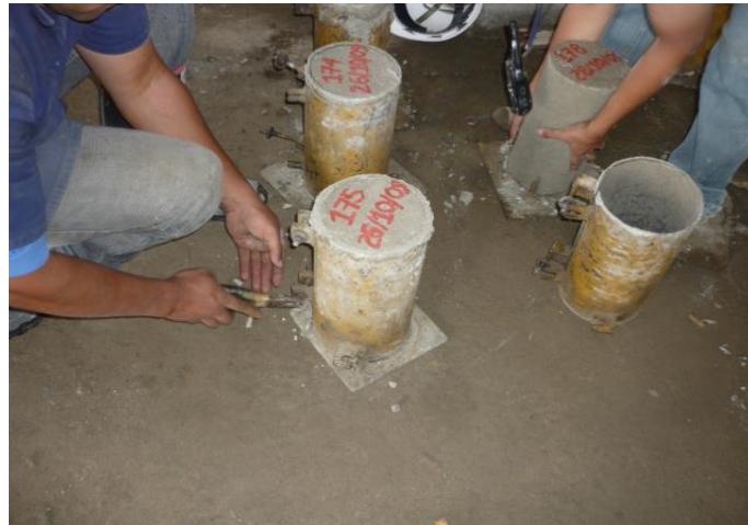
Figura 116. Marcación de los cilindros y desencofrado
