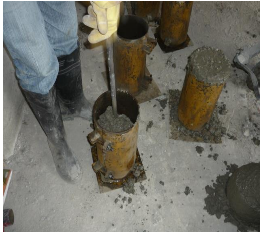
Figura 1412. Compactación de las capas
