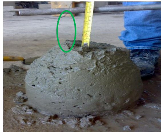
Figura 110. Slump tomado a mezcla sin aditivos Figura 111. Slump tomado a mezcla con plastificante
