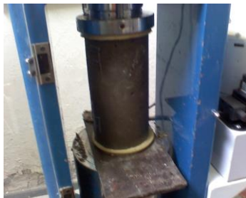
Figura No. 70 Fallando cilindro a compresión
