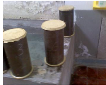
Figura No. 69 Cilindros preparados para fallarlos
