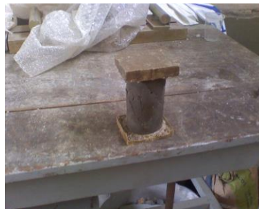
Figura No. 78 Fallo de muestra de grouting
