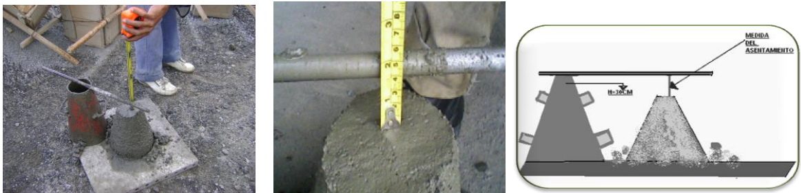
Figura No. 63 Medida del asentamiento de una mezcla de concreto con el Cono o Slump
