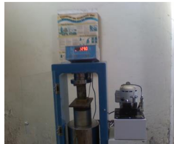
Figura No. 77 Compresión muestra de grouting
