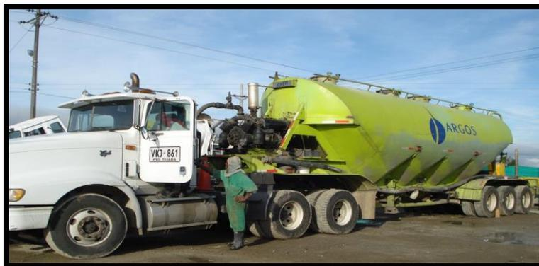
FOTO 1. CAMION TRANSPORTADOR DE CEMENTO
