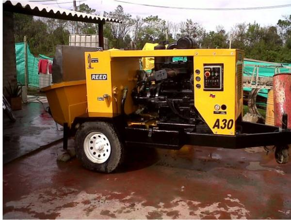
FOTO 25. BOMBA ESTACIONARIA DE CONCRETO
