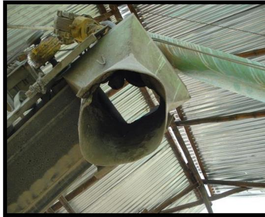
FOTO 13. CHUTE QUE RECIBE LOS AGREGADOS DE LA BANDA TRANSPORTADORA
