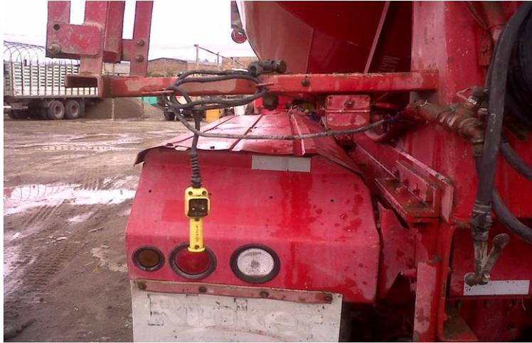
FOTO 20. MANDO DE LA OLLA DEL MIXER POR CONTROL REMOTO
