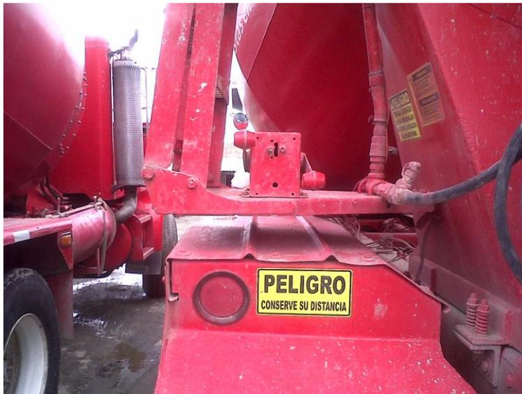
FOTO 21. MANDO DE LA OLLA DEL MIXER POR MEDIO DE PALANCAS
