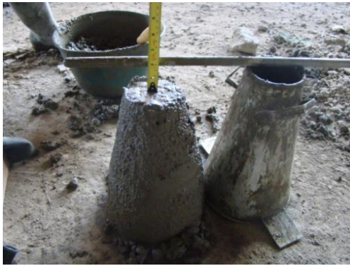
Figura N° 46. Medida del asentamiento de una mezcla de concreto con el cono o Slump para la losa
