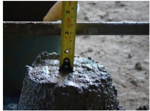
Figura N° 46. Medida del asentamiento de una mezcla de concreto con el cono o Slump para la losa
