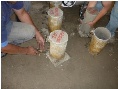
Figura N° 50. Desencofrado de los cilindros
