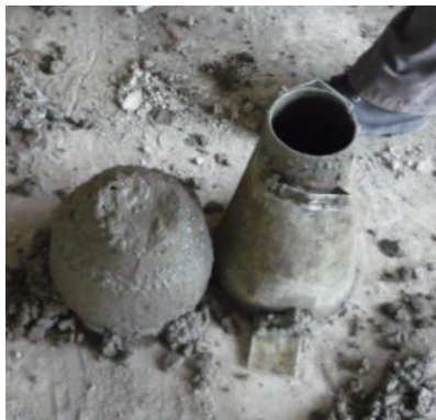
Figura N° 47. Medida del asentamiento para las columnas y pantallas
