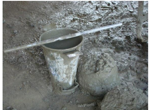
Figura N° 46. Medida del asentamiento de una mezcla de concreto con el cono o Slump para la losa
