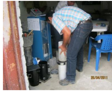
FIGURA 52. VISTA DE ACTIVIDAD DE ROTURA DE CILINDROS DE CONCRETO
