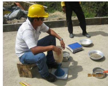
FIGURA 50. VISTA DE ACTIVIDAD DE CONTROL DE COMPACTACION DE LA CAPA DE SUBBASE GRANULAR
