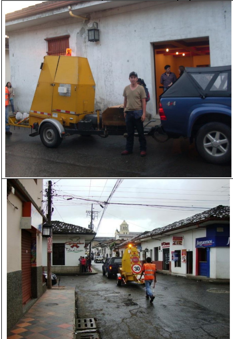
Figura No. 12 Deflectómetro de Impacto utilizado en el proyecto
