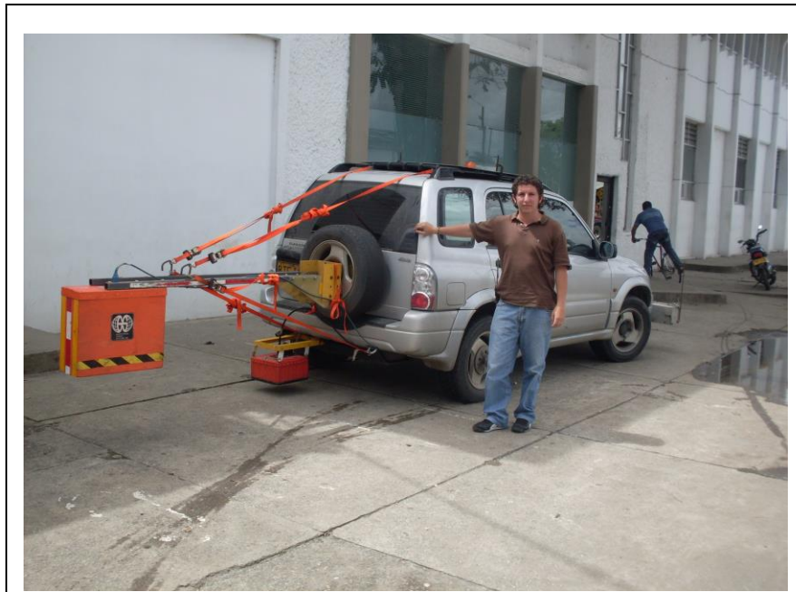
Figura No. 39 Georadar utilizado en el proyecto
