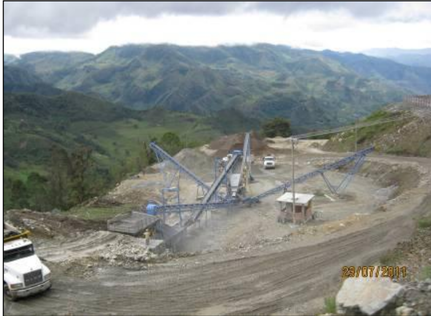
Figura 16. Planta de Trituración Tramo Gabriel López – Inzá.
