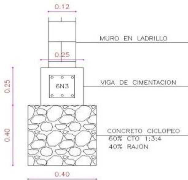
Figura 5. Cimentación de vivienda tipo
