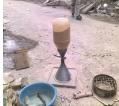
Figura No. 100 Cono de arena
