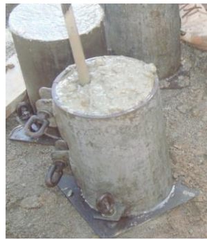
Figura No. 27 Proceso de llenado de cilindros
