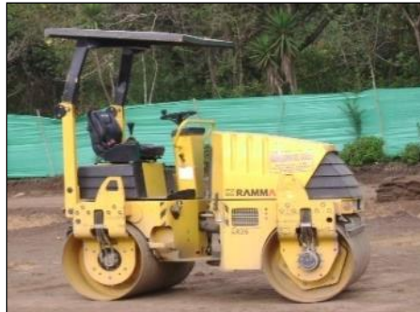
Figura No. 6 Vibro compactadora
