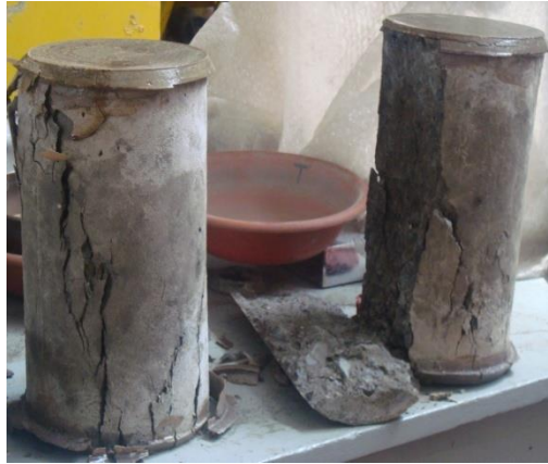
Figura No. 32 Cilindro fallado completamente
