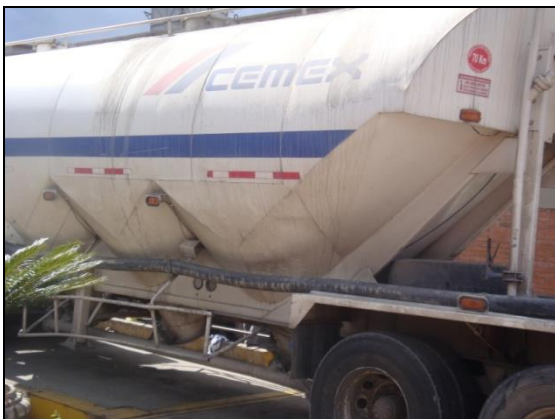
Foto 5. Transporte de cemento
