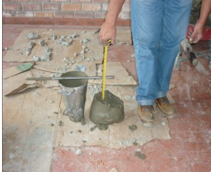
Foto 14. Ensayo de asentamiento
