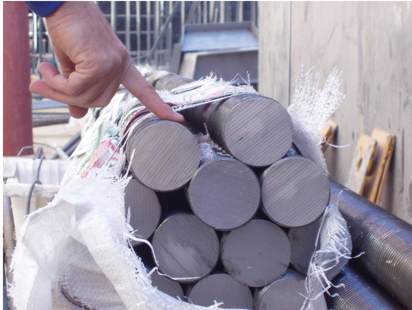
Foto 17. Detalle de Barras de Alta resistencia.
