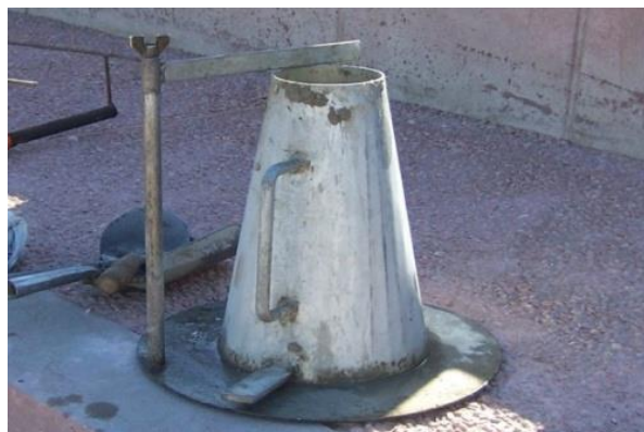
Figura 9. Cono de Abrams, para ensayo slump.
