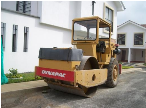
Foto 93 Compactador de tambor vibratorio
