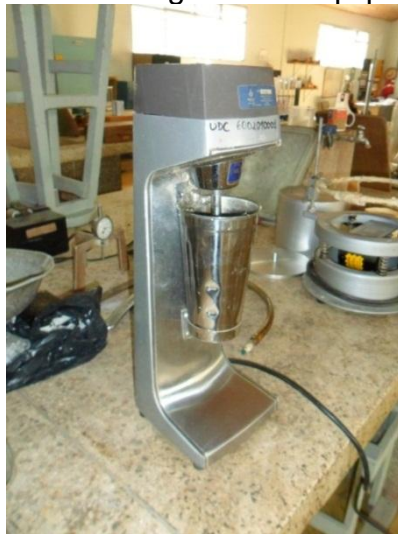
Figura 13. Equipo para gravedad específica.
