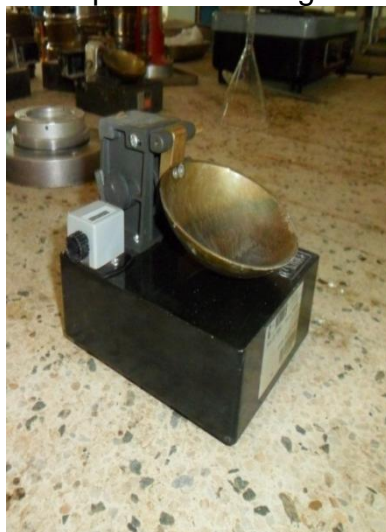
Figura 15 Capsula de Casagrande y muestras para Limites de Consistencia.
