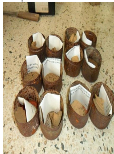
Figura 15 Capsula de Casagrande y muestras para Limites de Consistencia.
