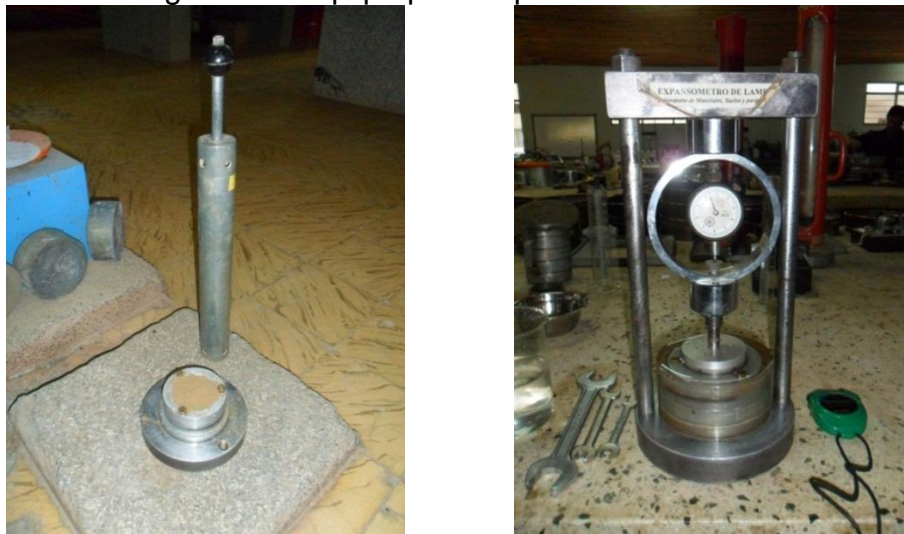
Figura 14. Equipo para expansión de lambe.
