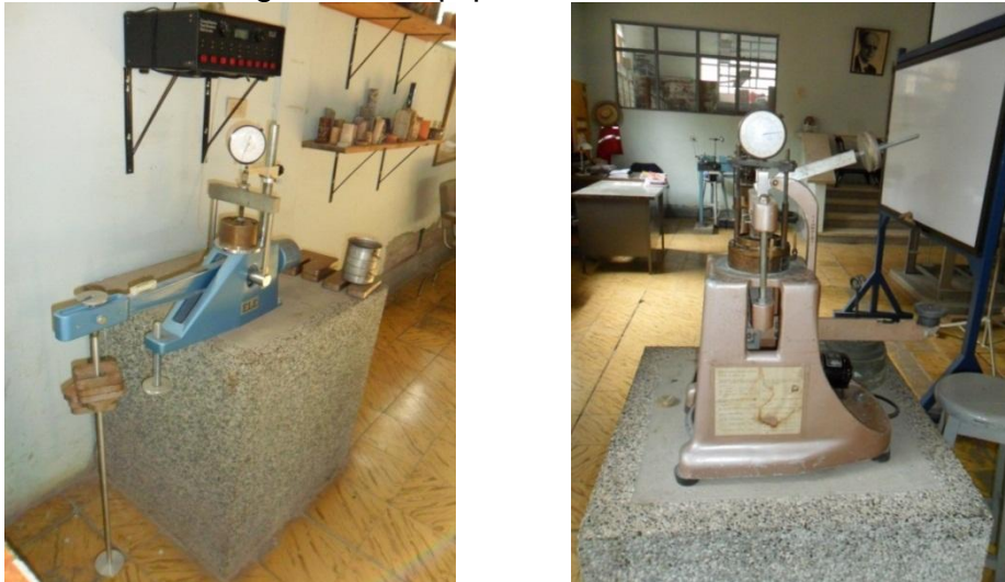
Figura 12. Equipo de consolidación.
