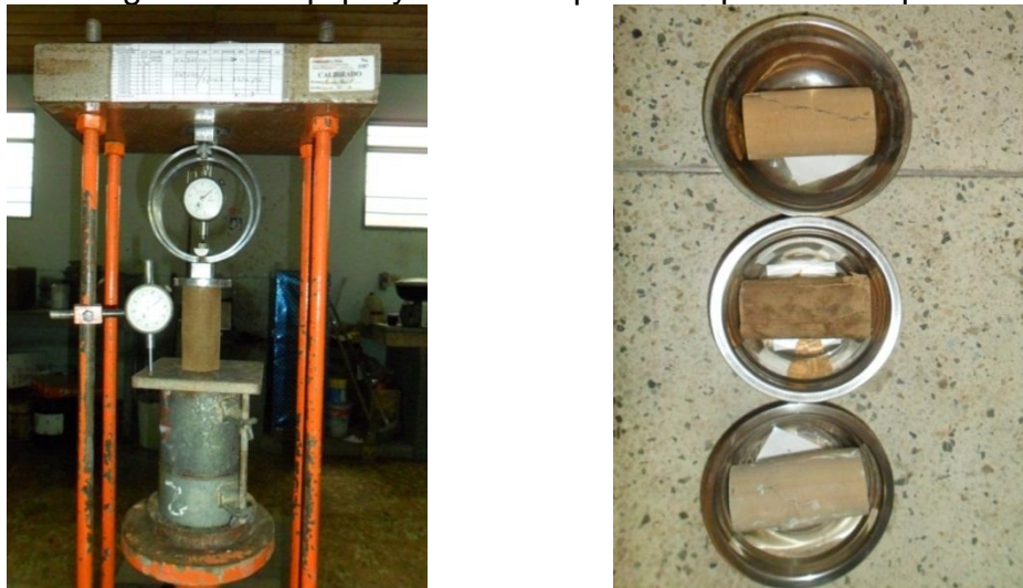
Figura 16. Equipo y muestras para compresión simple.
