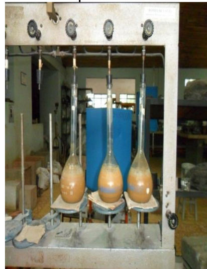
Figura 13. Equipo para gravedad específica.
