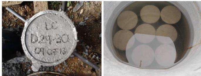
**Figura 28.** Probetas de cilindros de concreto
