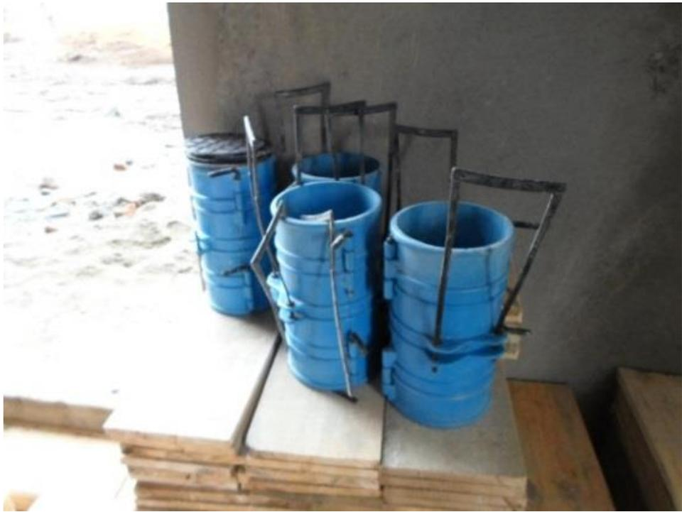
**Figura No. 175: formaleta para cilindros ensayo de resistencia**
