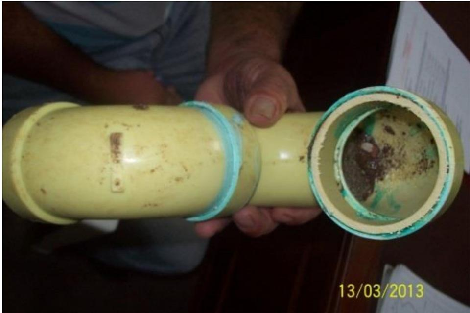
**Figura No. 215: taponamiento encontrado en tubería**
