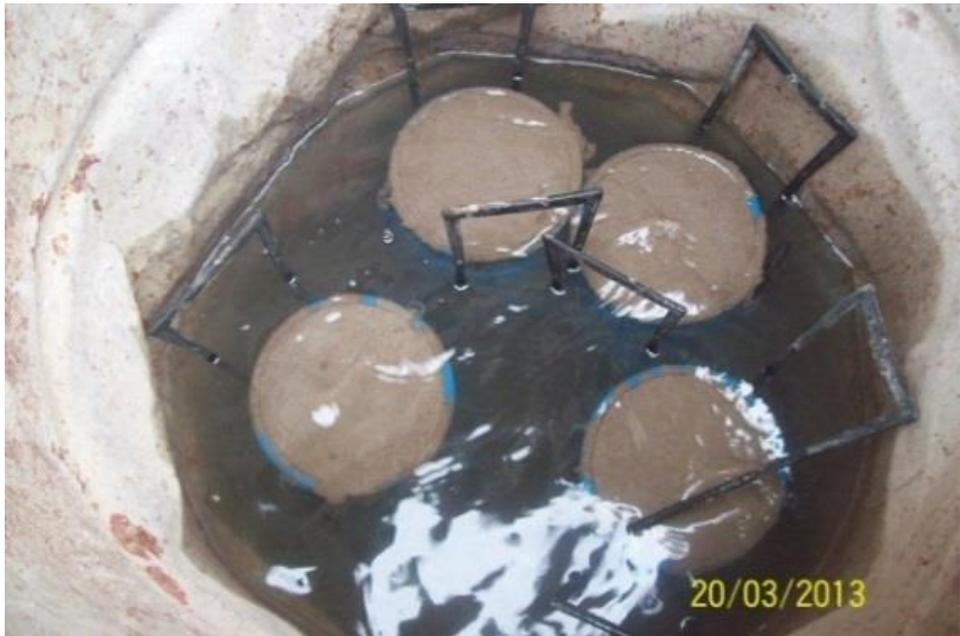
**Figura No. 176 cilindros para evaluar resistencia**
