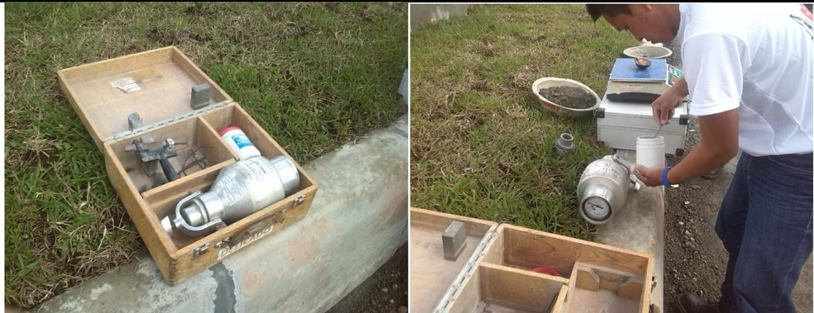
IMÁGENES No. 46. DETERMINACIÓN DE LA HUMEDAD DE LA CAPA COMPA DE BASE GRANULAR COMPACTADA, UTILIZANDO CARBURO DE CALCIO.
