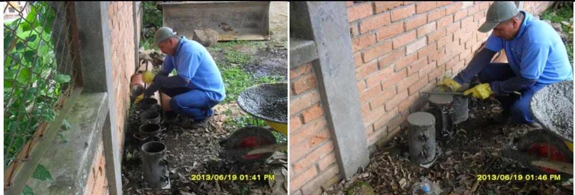
IMÁGENES No. 54. LLENADO DE CILINDROS PARA ENSAYO DE COMPRESIÓN.
