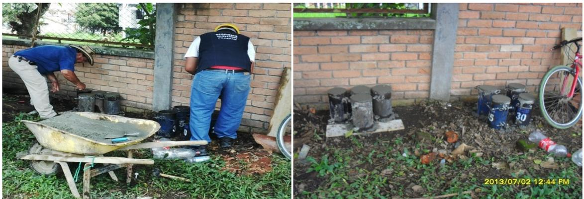
IMÁGENES No.62. LLENADO DE CILINDROS PARA EL CONTROL DE CALIDAD DE LA RESISTENCIA A LA COMPRESIÓN
