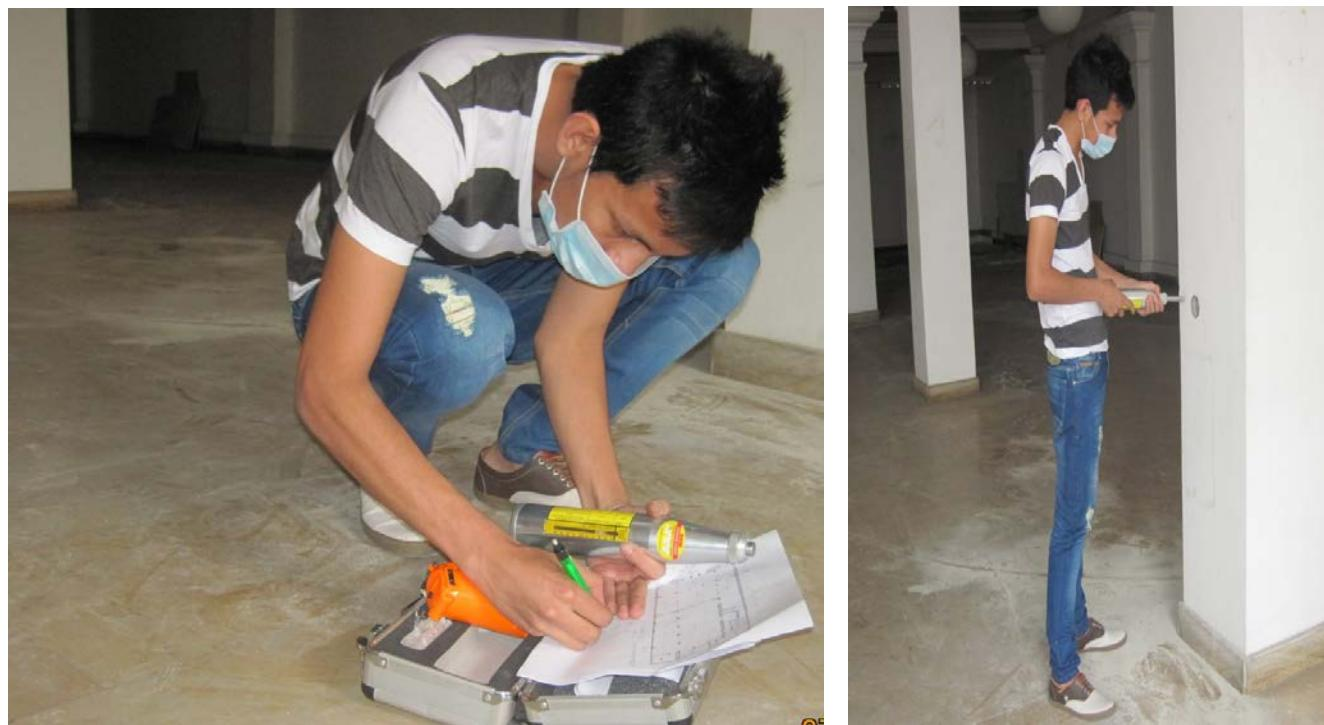
**Figura 25.** Fotografías del ensayo con esclerómetro de campo
