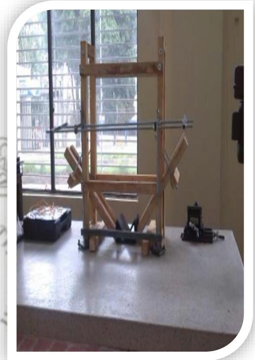
Foto 20 Marco para el sostenimiento de los muretes y base de los deformímetros
