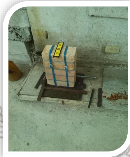
Foto 16 Nivelación del prisma en el proceso de refrentado
