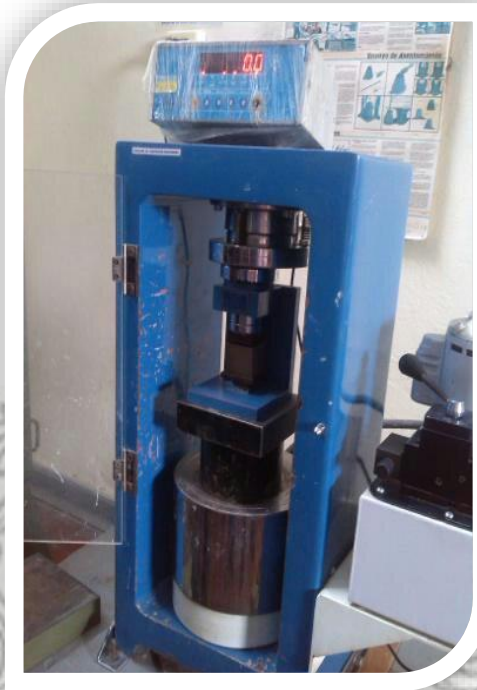
Foto 8 Cubo en la máquina a compresión para ser ensayado
