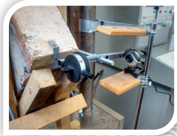
Foto 22 Montaje de cámara web y deformímetro lateral
