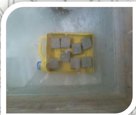
Foto 7 Cubos sumergidos en agua -cal saturada dentro del tanque de almacenamiento
