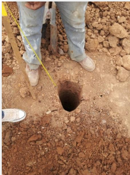
Figura 10. Toma de muestras inalteradas
