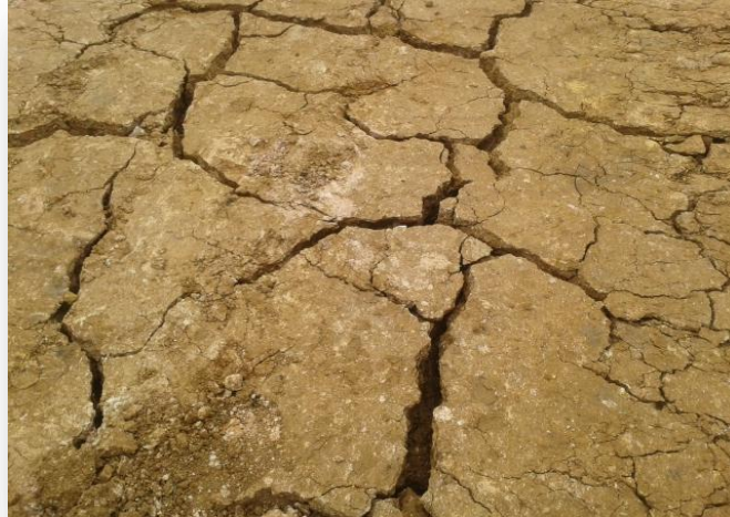
Figura 12. Agrietamiento de terrazas debido a temporada de sequía
