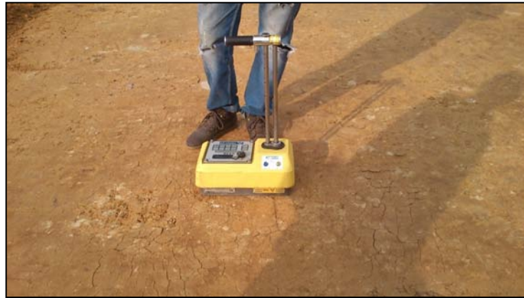
Gráfica 58. Aplicación de Prueba de Densidad con Densímetro Nuclear
