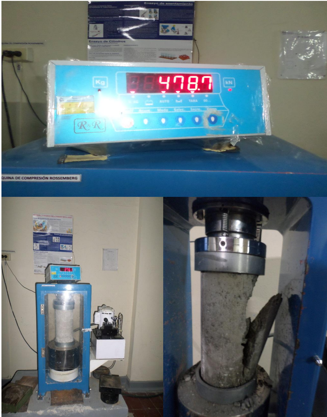
Fig. 43. Montaje y resultados de la prueba de carga para determinar f'_c
