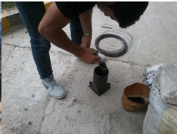
Fig.6. Cilindros de 15x30cm para determinar Resistencia a la compresión
