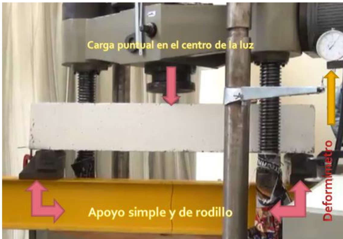
Fig.50. Montaje del ensayo
