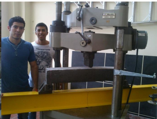
Fig.8. Viga lista para someter a carga en el laboratorio de estructuras
