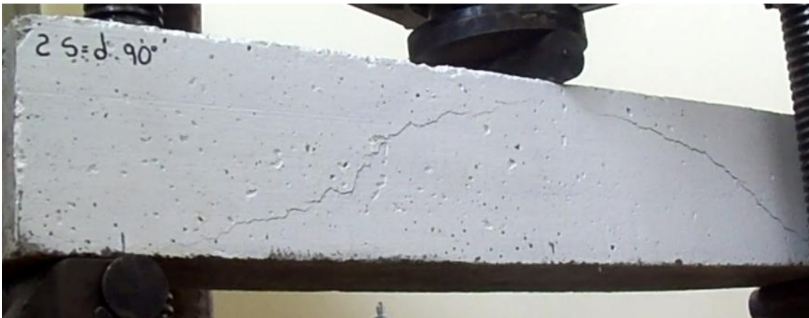
Fig.67. Aparición de la fisura en el otro sentido
