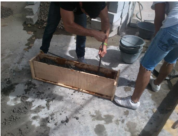
Fig.5. Apisonado de las capas según la norma NTC
