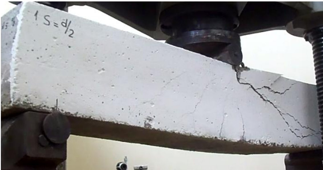
Fig.77. Fisuras de efectos combinados, flexión, compresión y cortante
