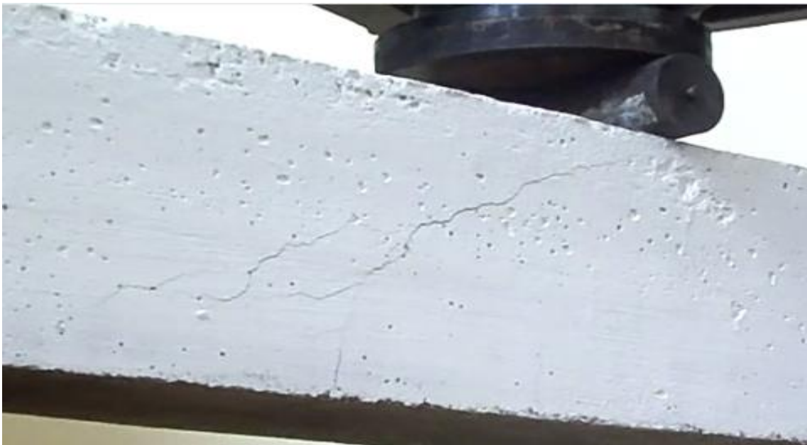
Fig.61. Fisura de “cortante en el alma” o “de tracción diagonal”
