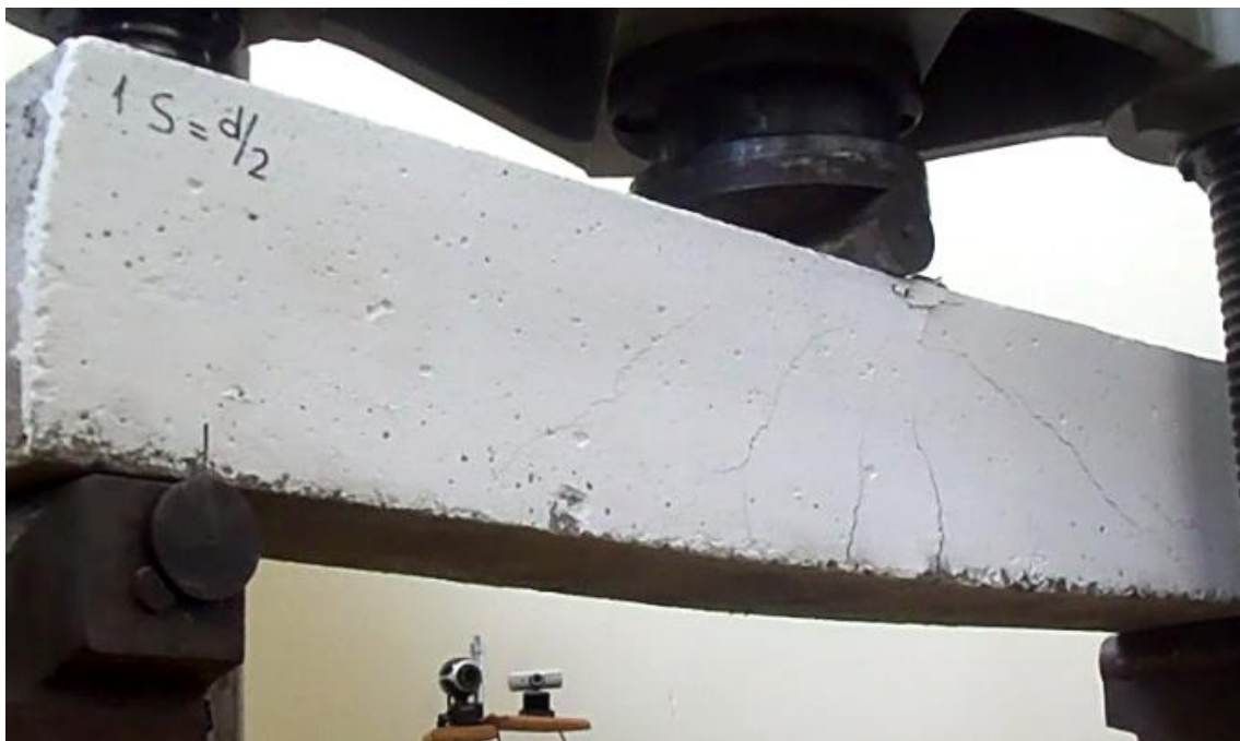
Fig.76. Fisuras de flexión-cortante
