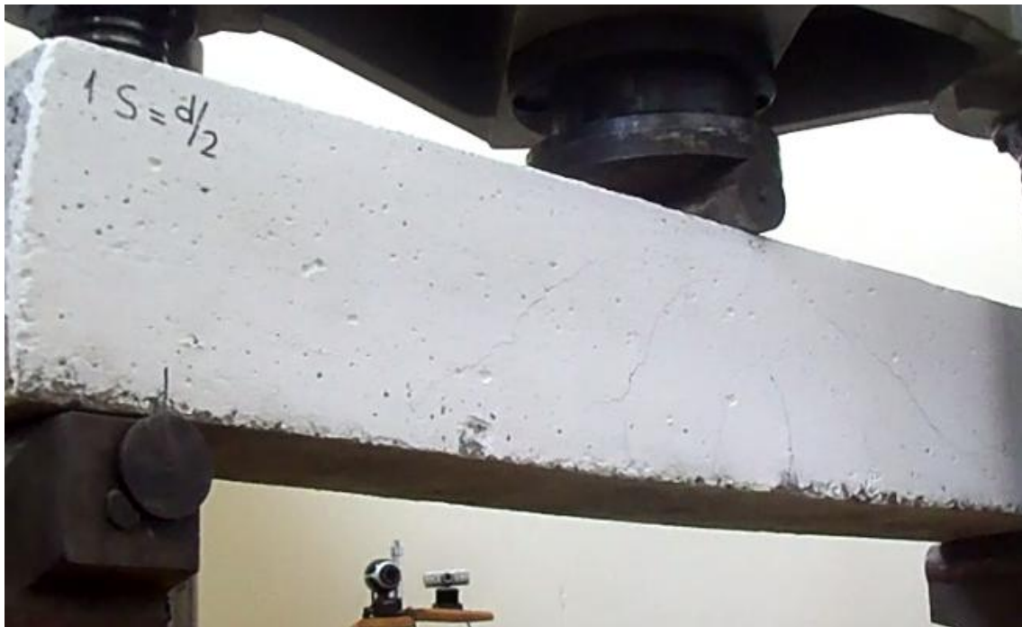
Fig.75. Aparición de fisuras de cortante en el alma y flexión-cortante (Viga1)
