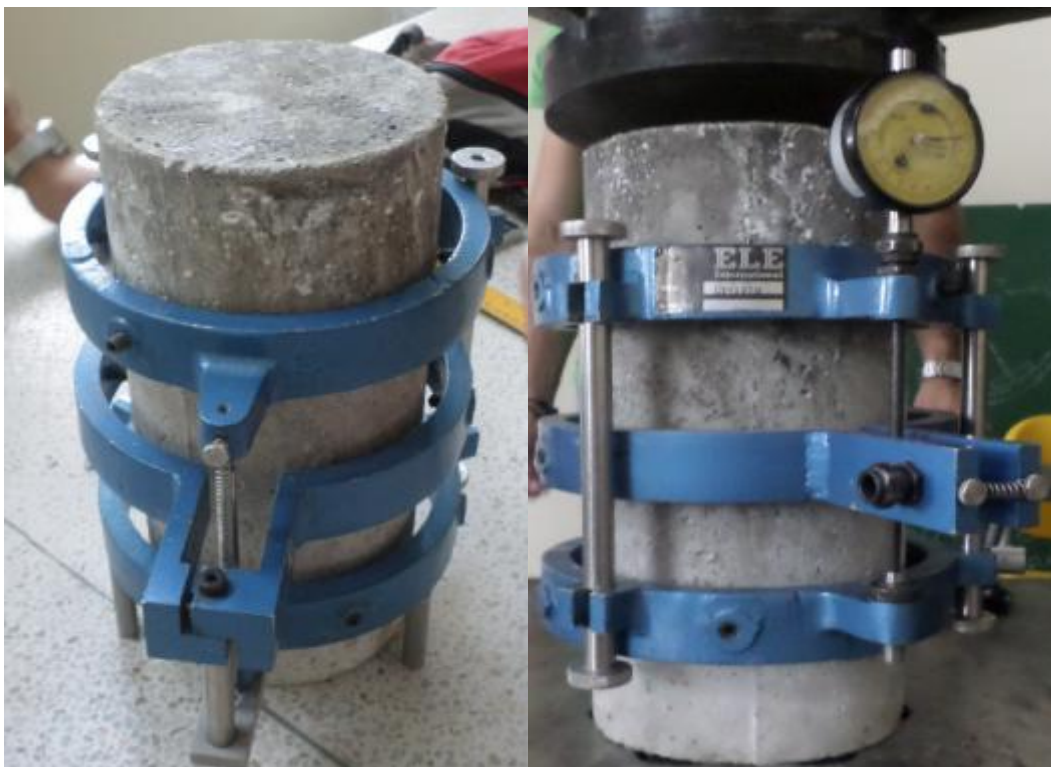
Fig.44. Equipo necesario para determinar el módulo de elasticidad del concreto
