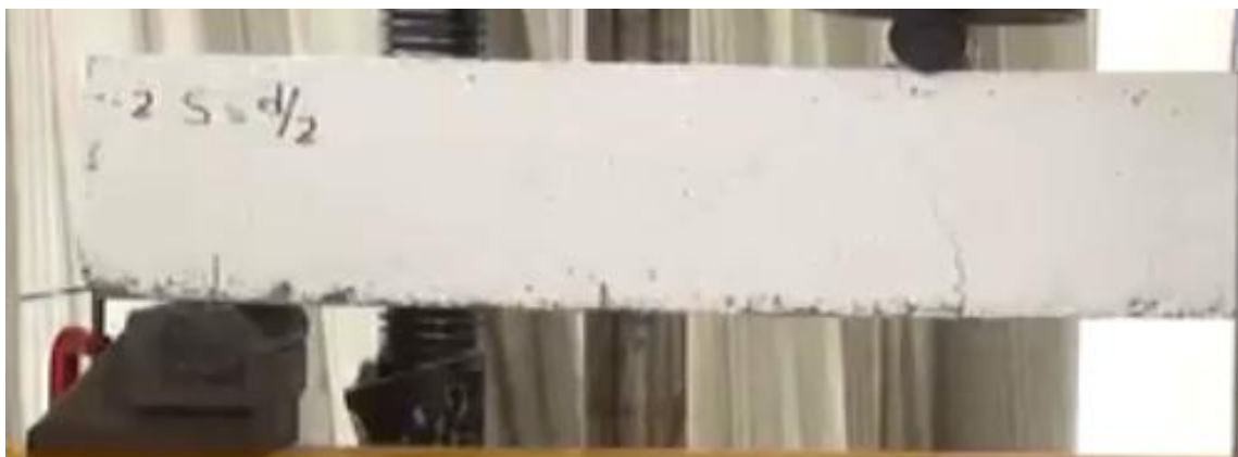
Fig.74. Aparición de fisuras de flexión (Viga2)
