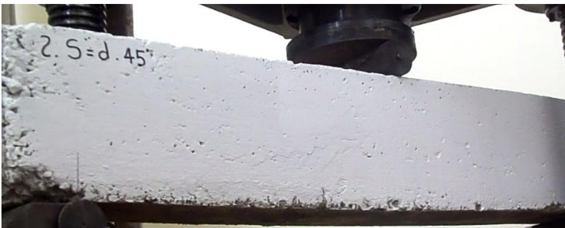
Fig.70. Aparición de las fisuras de cortante en el alma tímidamente (Viga 2)
