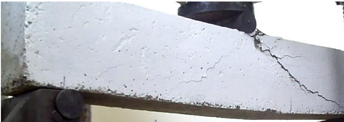
Fig.72. Viga 1 Con estribos a 45° Fallada
