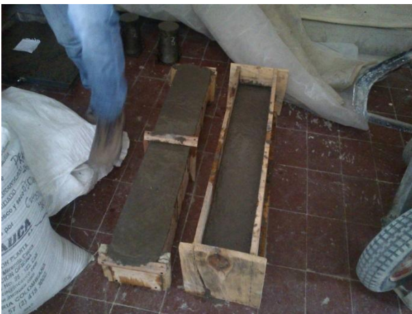
Fig.7. Vigas listas para curado durante 28 días en agua-cal
