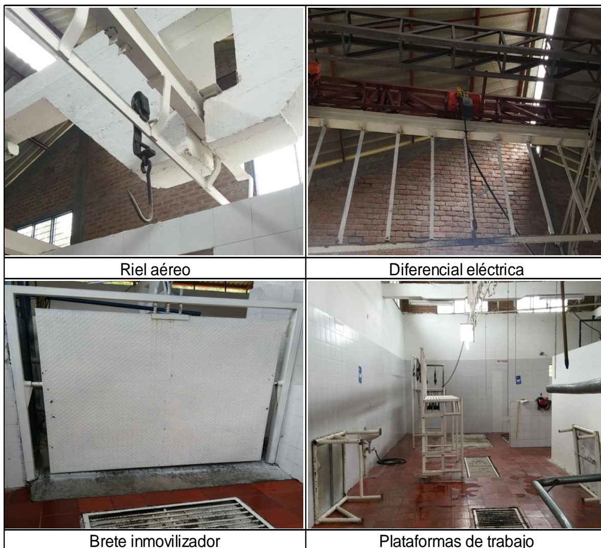
Imagen 7. Instalaciones e instrumentos para el sacrificio de ganado del matadero de Inzá (Fuente: Autoría propia)
