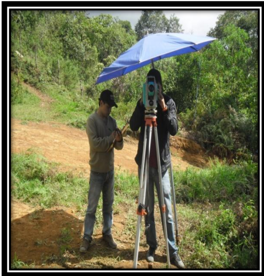
Figura 9. Lectura de topografía desde E1
