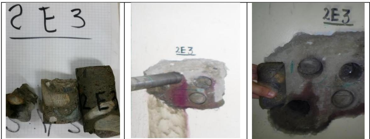
Figura 38. 2E3: Columna segundo piso del eje transversal E y el eje longitudinal 3 - Fuente: Propia de la investigación.
