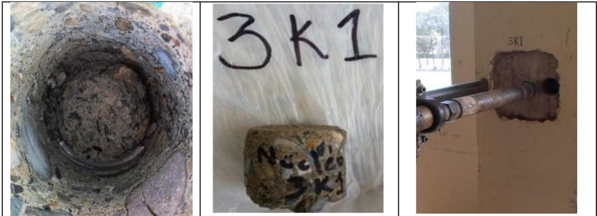
Figura 30. 3K1: Columna tercer piso del eje transversal K y el eje longitudinal 1- Fuente: Propia de la investigación.
