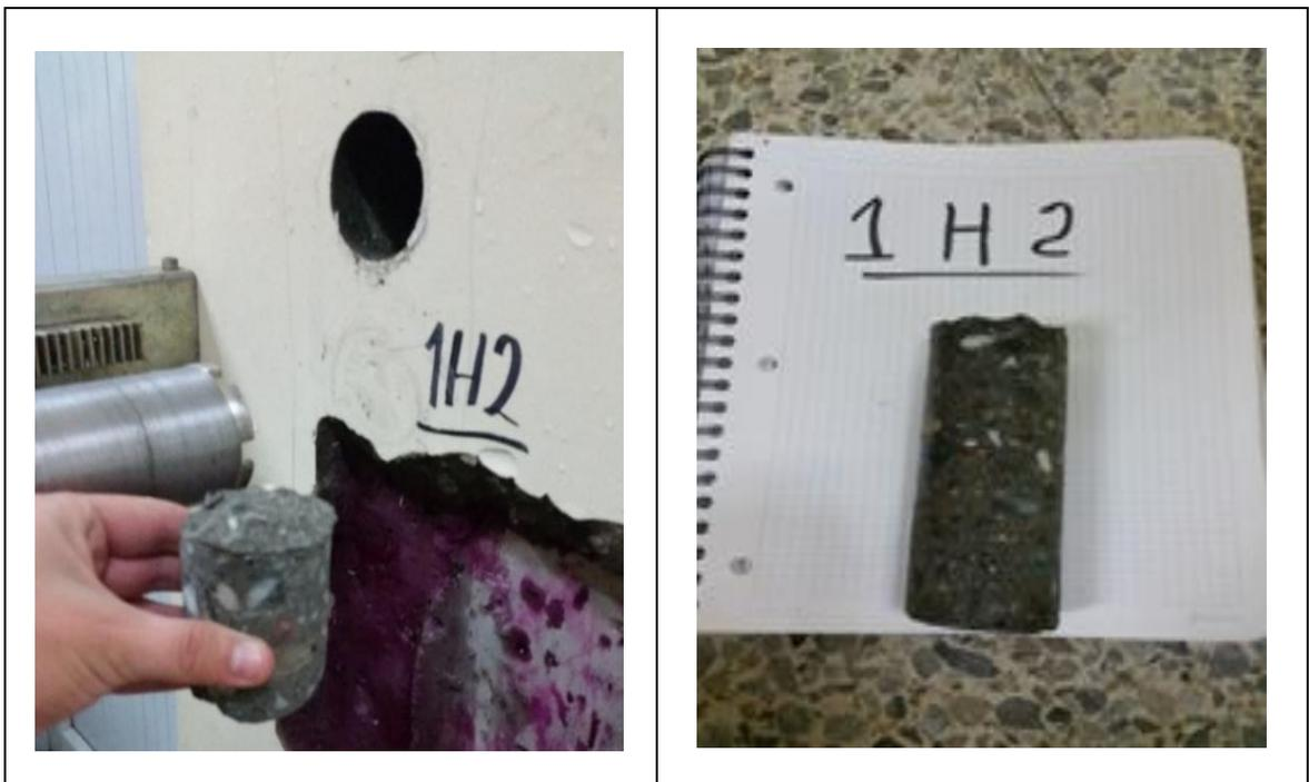
Figura 47. 1H2: Columna primer piso del eje transversal H y el eje longitudinal 1 – Fuente: Propia de la investigación.
