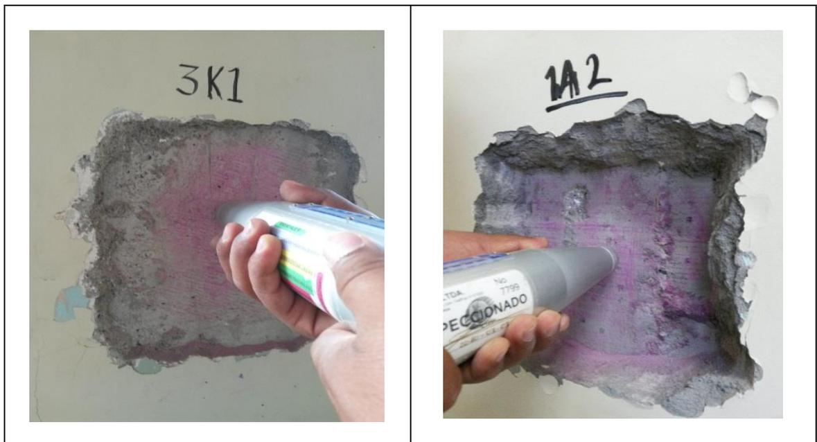
Figura 17. Toma de esclerometria a los elementos estructurales, siguiendo lo descrito en la INV E 413-13 – Fuente: Propia de la investigación.
