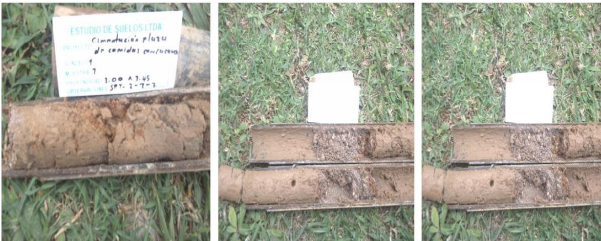
Con las muestras obtenidas se llevaron a cabo ensayos de campo para estimar la resistencia a la compresión inconfiada con penetrometro de mano. También se hicieron ensayos de laboratorio con el fin de determinar su contenido de agua en estado natural, distribución granulométrica, peso unitario, límites de consistencia y resistencia a la compresión inconfiada.
