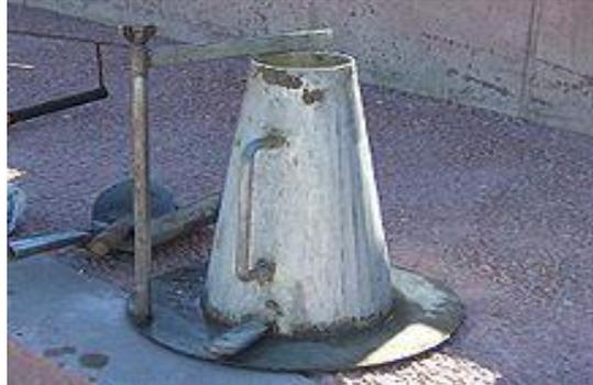
El ensayo consistencia se realizó al concreto de todos los elementos estructurales que así lo requerían y en todos estos el asentamiento fue de 5 cm.
