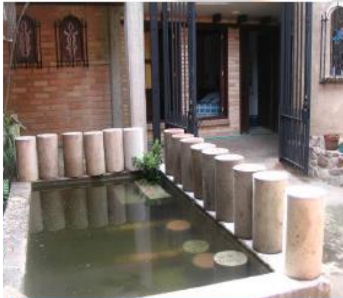
Figura 3 Curado de Cilindros de concreto
