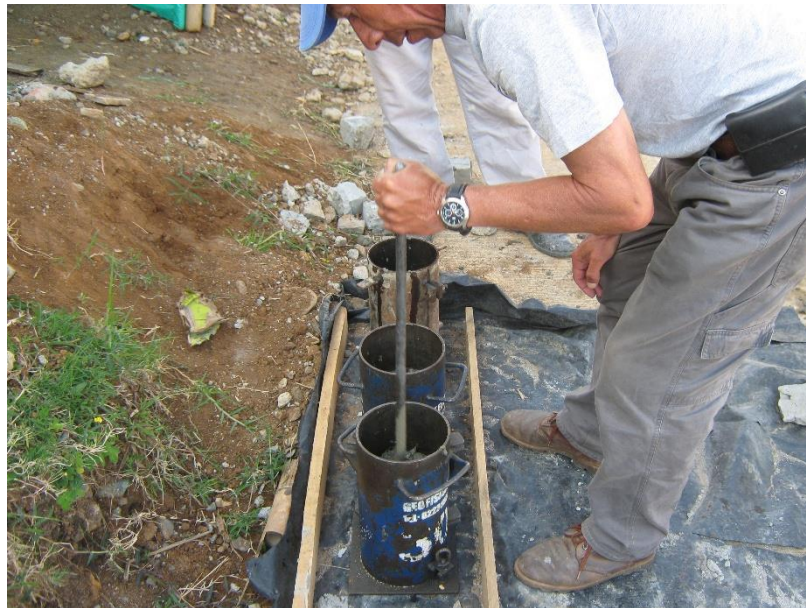
Fig. 39 Llenado de cilindros para ensayo de resistencia a compresión.
