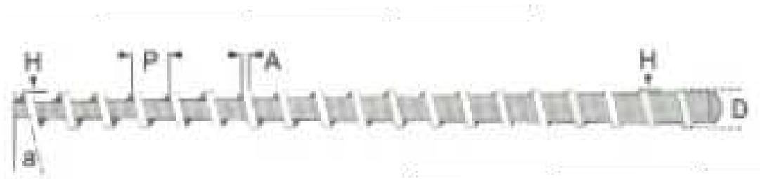
D: Diámetro, P: Paso de ancho de canal, A: Ancho del Filete, H: Altura del canal, a: Angulo de la hélice.
