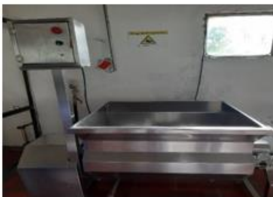
Figura 28. Vista del exterior de la Hiladora de queso.
