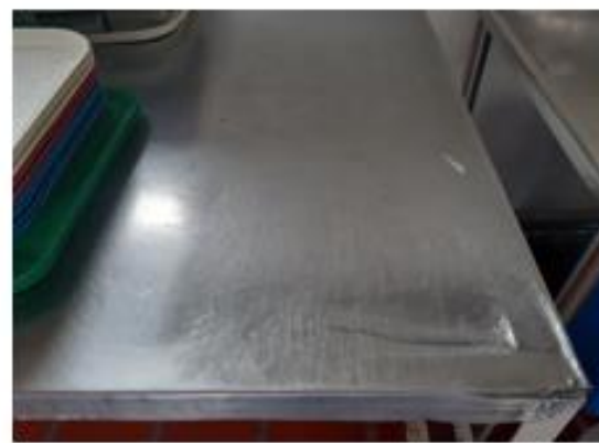
Figura 31. Mesa de trabajo que presenta deterioro en una de sus esquinas.
