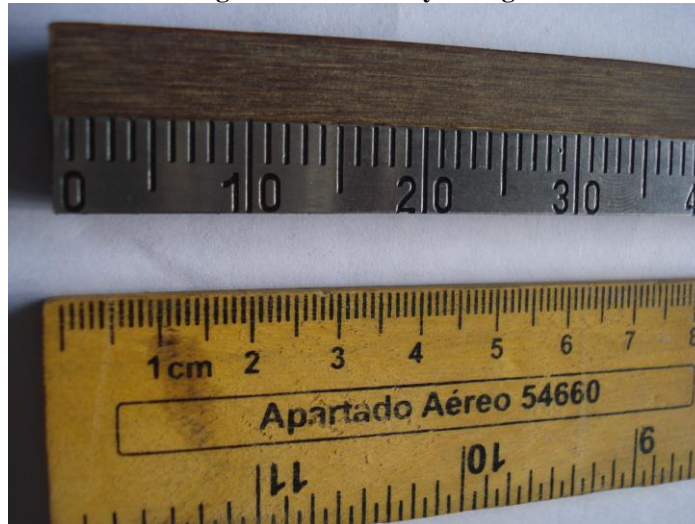
Figura 36. Comparación entre la Regla Pluviométrica y la Regla Métrica.
