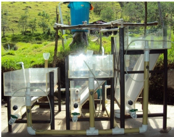
Foto 3. Planta piloto instalada en la Estación Piscícola Chiliglo.
