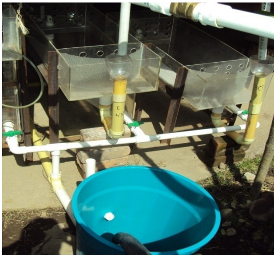
Foto 7. Sistema de entrada del flujo a los estanques piloto.
