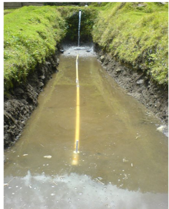
Foto 3. Sistema de recolección de agua y sólidos en el estanque a escala real.
