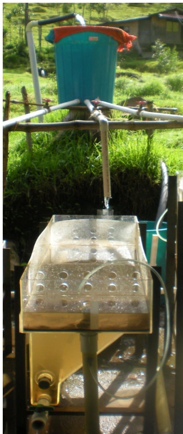
Foto 6. Tanque de cabeza constante (arriba) y estanque piloto en operación (abajo).
