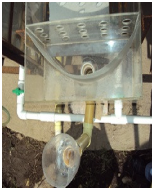
Foto 4. Estructura de ingreso al estanque piloto.
