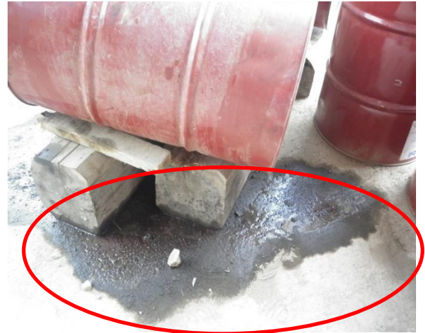
En la Planta de Triturados se evidencia zona de combustible inundada y contaminación directa al Suelo.
